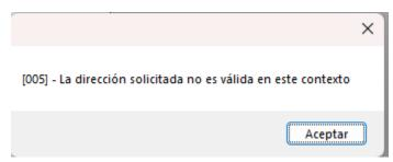
En este caso se tiene que configurar la ip como en el apartado <u>Configuración de la interfaz</u>, donde se verifica la dirección ip con la consola y si es diferente se pone la misma dirección ip de la computadora para que pueda vivir el LIS
