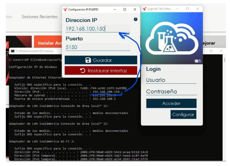
Y listo, con esto la interfaz debería de arrancar correctamente en dado caso de haber 2 direcciones ip y una no funcione prueban con la otra
